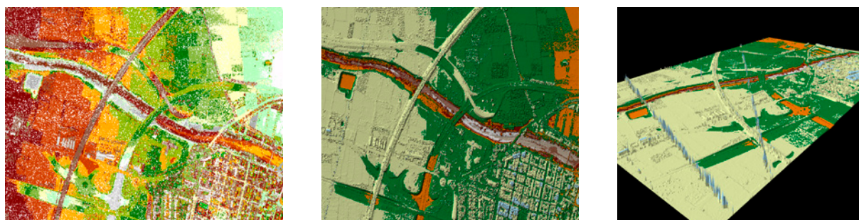
Figura 2. De izquierda a derecha: nube de puntos LiDAR bruto (archivo *.LAZ/*.LAS), MDT con nube de puntos LiDAR bruto y Vista 3D MDT con nube de puntos LiDAR bruto. Fuente: elaboración propia.
